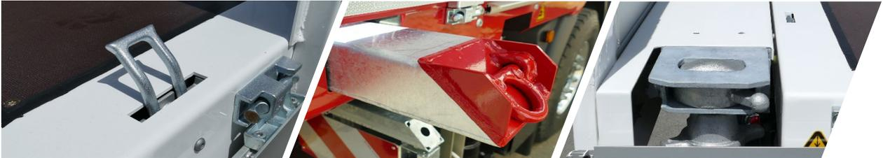
Zurrhaken, manuell ausziehbare Containerauflager und Containerverriegelungen bieten beste Voraussetzungen für den sicheren Transport schwerer und breiter Güter.
