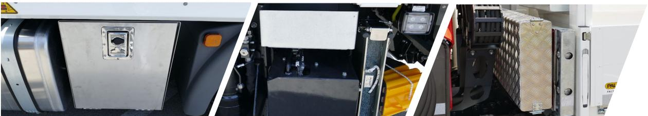
Kranzubehör und Lastaufnahmemittel können sicher in einer Edelstahlbox mit Furnierholzkorpus aufbewahrt werden. Schwere Ketten verstaut man am besten in den Boxen an der Zusatzabstützung, wo sie einfach mit dem Kran einfach aufgenommen werden können. Die zweiteilige Teleskopleiter wird in einer Box zwischen Kran und Pritsche aufbewahrt.
