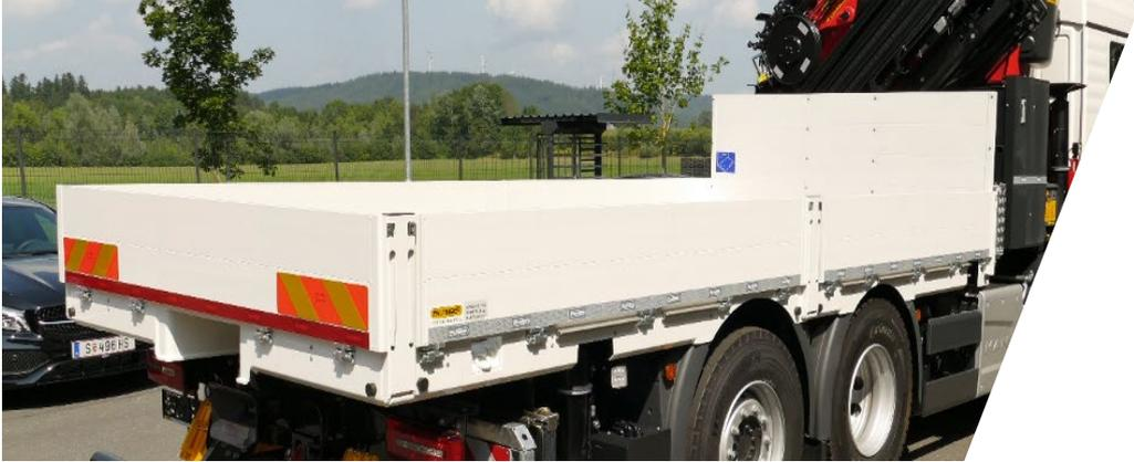
Die Pritsche mit integrierten Ausschnitten für die Kotflügel ist seitlich am Hilfsrahmen angesetzt um die Ladehöhe so niedrig wie möglich zu halten.
