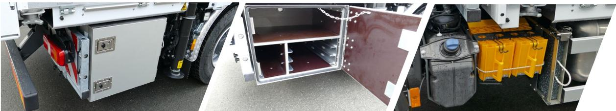
Die Bordwände können sicher in einer Edelstahlbox mit Furnierholzkorpus am Heck des Fahrzeuges aufbewahrt werden. Unterlegplattenhalter und Unterlegkeile sind griffbereit am Fahrzeug montiert.
