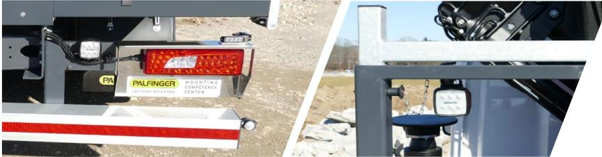
Für die optimale Ausleuchtung des Einsatzortes sorgen 2 LED-Arbeitscheinwerfer und 6 LED- Rückfahrcheinwerfer. Zusätzlich ist dieses Fahrzeug noch mit 6 Blitzleuchten und 2 Umrissleuchten ausgestattet.
