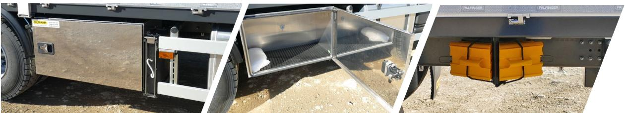
Auf der linken und rechten Seite ist je eine große Werkzeugkiste aus Edelstahl verbaut. Unterlegplattenhalter und Unterlegkeile sind griffbereit am Fahrzeug montiert.
