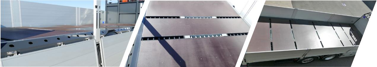
Das 45° abgeschrägte Umrandungsprofil hat ca. alle 170mm Zurrlöcher integriert. Mit den 6 Zurrschienen quer zur Pritsche kann die Ladung zusätzlich mit Steckungen und Spanngurten gesichert werden.
