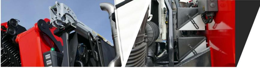
Das MFA-Jib kann für den Transport platzsparend über dem Krantank abgelegt werden. Bei Kranen mit Arbeitskorb gewährleisten 2 Aggregate einen sicheren Notbetrieb, sollte die Kransteuerung mal ausfallen.
