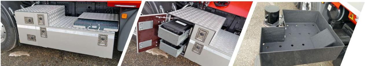
Kranzubehör und Lastaufnahmemittel können sicher in den Alu-Werkzeugbox mit Furnierholzkorpus aufbewahrt werden. In einer weiteren Kiste werden die Fahrzeugbatterien gut zugänglich verbaut. Schwere Ketten verstaut man am besten in den Boxen an der Zusatzabstützung, wo sie einfach mit dem Kran einfach aufgenommen werden können.
