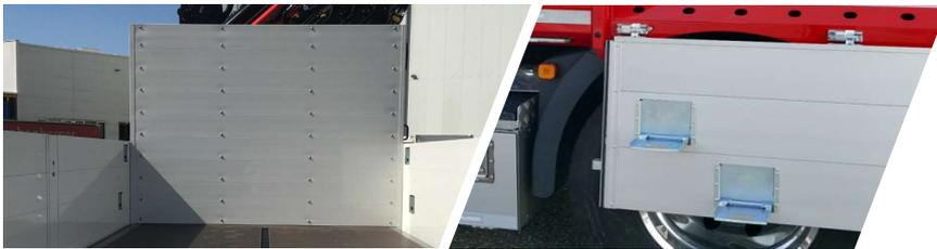
Eine Stirnwand und Bordwände aus Alu-Profilen umrahmen die Pritsche. Die Ladefläche ist über integrierte Klappritte einfach zu erreichen.
