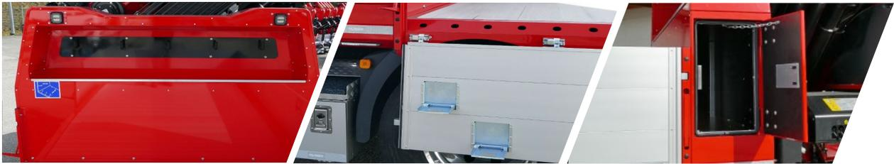
Die ansprechende Stirnwand beinhaltet eine integrierte durchgängiger Staubox, Haken zum Ablegen von Gurten und 4 LED-Arbeitscheinwerfern. Ein robuster Alu-Boden und Zurrpunkte im Umrandungsprofil garantieren einen sorgenfreien Transport über viele Jahre. Der Aufstieg auf die Ladefläche wird über in der Bordwand integrierte Klapptritt ermöglicht.
