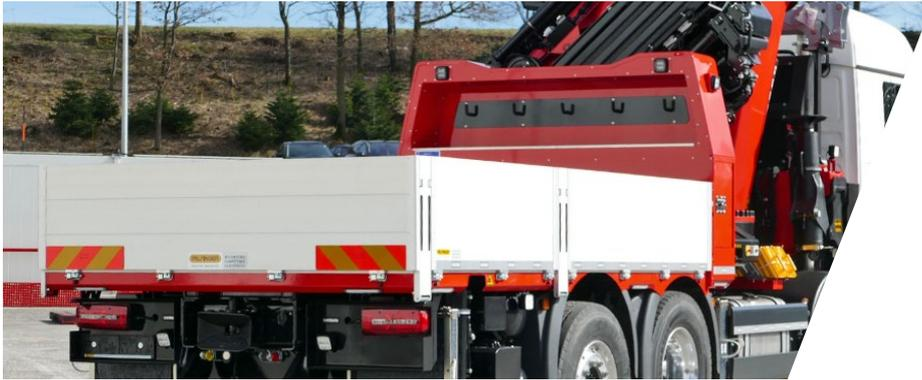
Die Pritsche mit integrierten Ausschnitten für die Kotflügel ist seitlich am Hilfsrahmen angesetzt um die Ladehöhe so niedrig wie möglich zu halten. Die von PALFINGER entwickelte Design-Stirnwand ist nicht nur praktisch, sondern auch optisch ein Hingucker.
