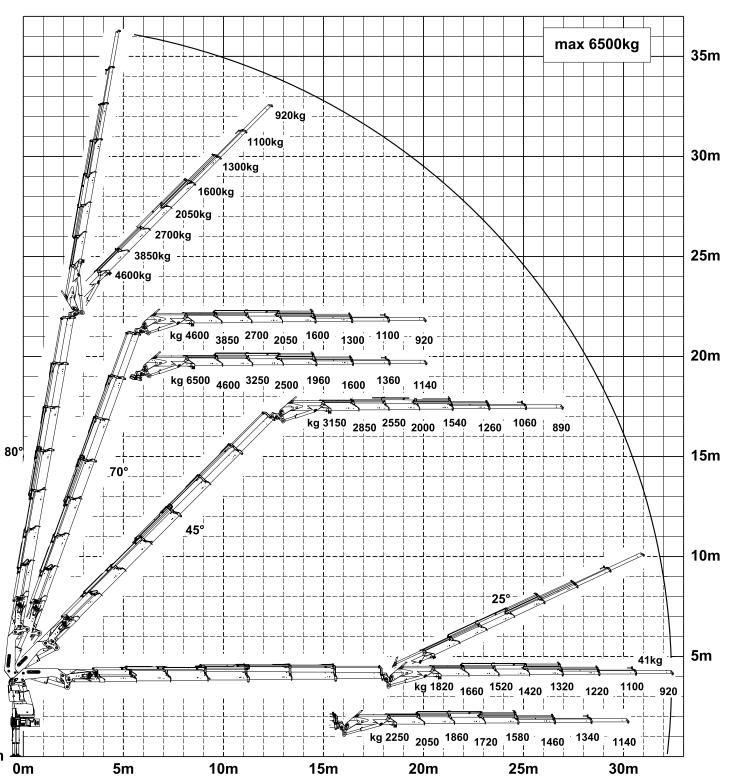
Die Tragkräfte laut Diagramm verringern sich bei Verwendung von mechanischen Verlängerungen um deren Eigengewicht. Krandarstellung symbolisch, Angaben bei 20° Hauptarmstellung & Lastarm horizontal
