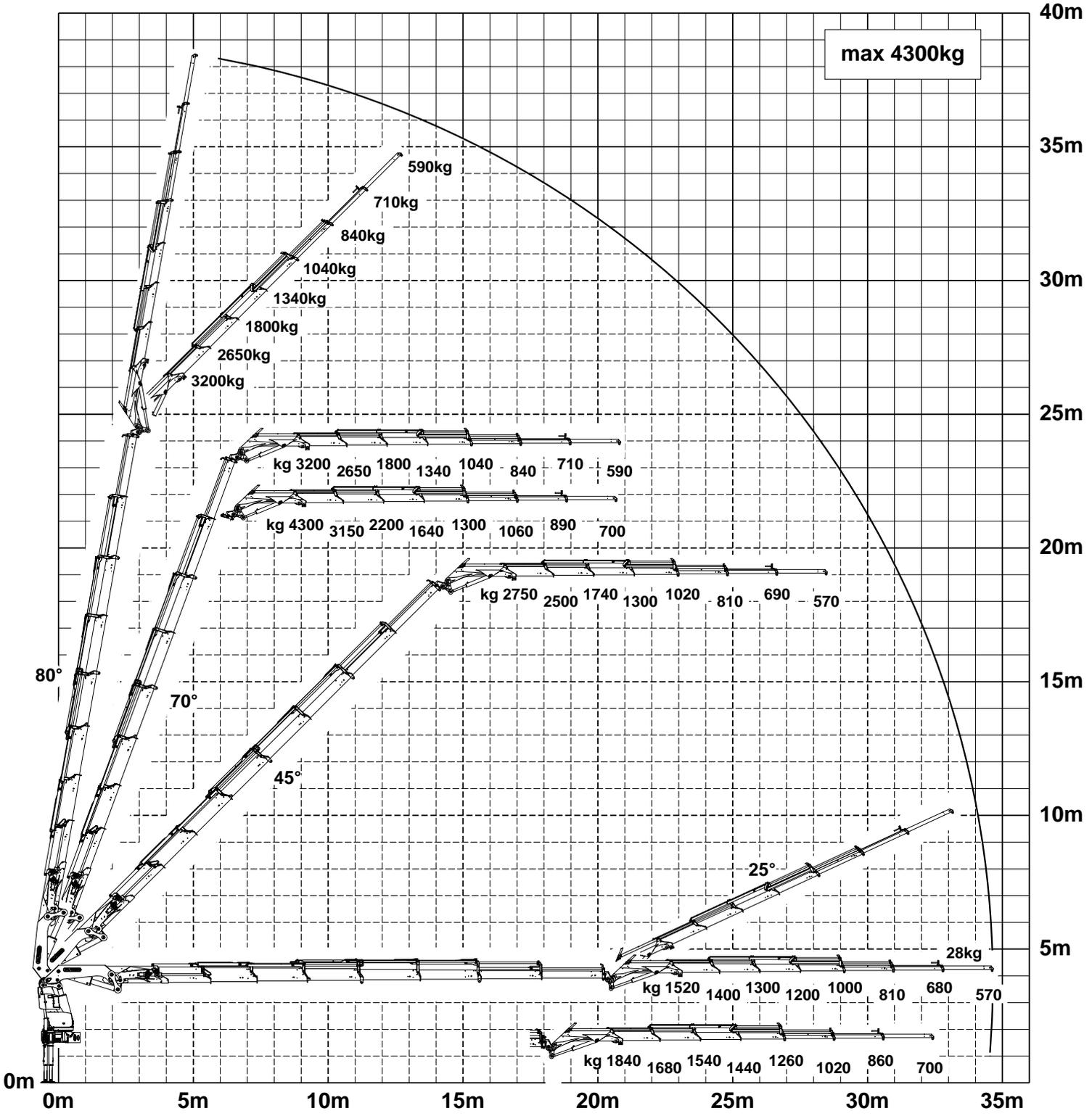
Die Tragkräfte laut Diagramm verringern sich bei Verwendung von mechanischen Verlängerungen um deren Eigengewicht. Krandarstellung symbolisch, Angaben bei 20° Hauptarmstellung & Lastarm horizontal
