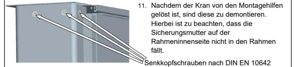
11. Nachdem der Kran von den Montagehilfen gelöst ist, sind diese zu demontieren. Hierbei ist zu beachten, dass die Sicherungsmutter auf der Rahmeninnenseite nicht in den Rahmen fällt.
