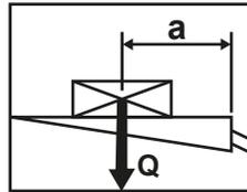
La carga útil máxima permitida (**Q**) depende de la distancia de carga (**a**). La distancia de carga (**a**) es la distancia entre el borde trasero de la plataforma de carga y el centro de gravedad de la carga útil (**S**).
