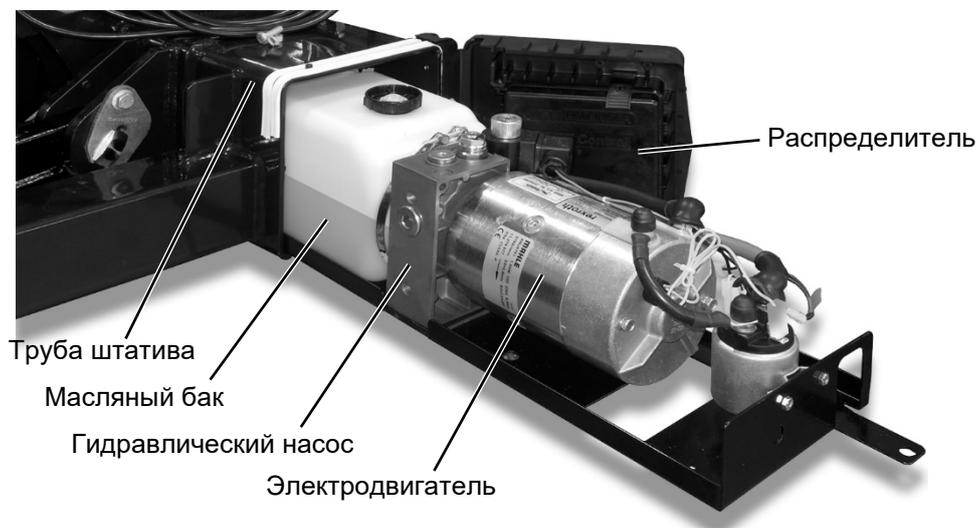
Рисунок 49: Гидравлический агрегат
