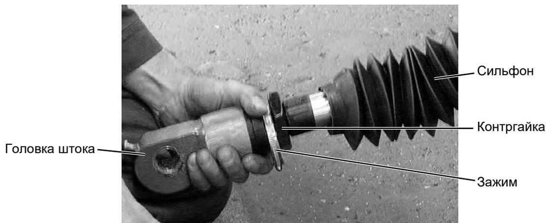
Рисунок 35: Цилиндр опрокидывания
