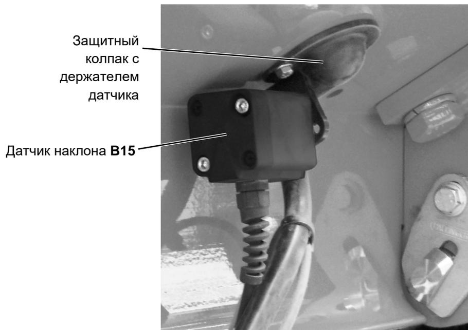
Рисунок 41: Защитный колпак с датчиком наклона **B15**
