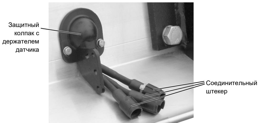
Рисунок 40: Защитный колпак с держателем датчика для датчика наклона **B15**
