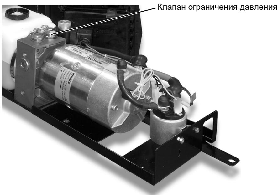
Рисунок 50: Клапан ограничения давления на гидравлическом агрегате
