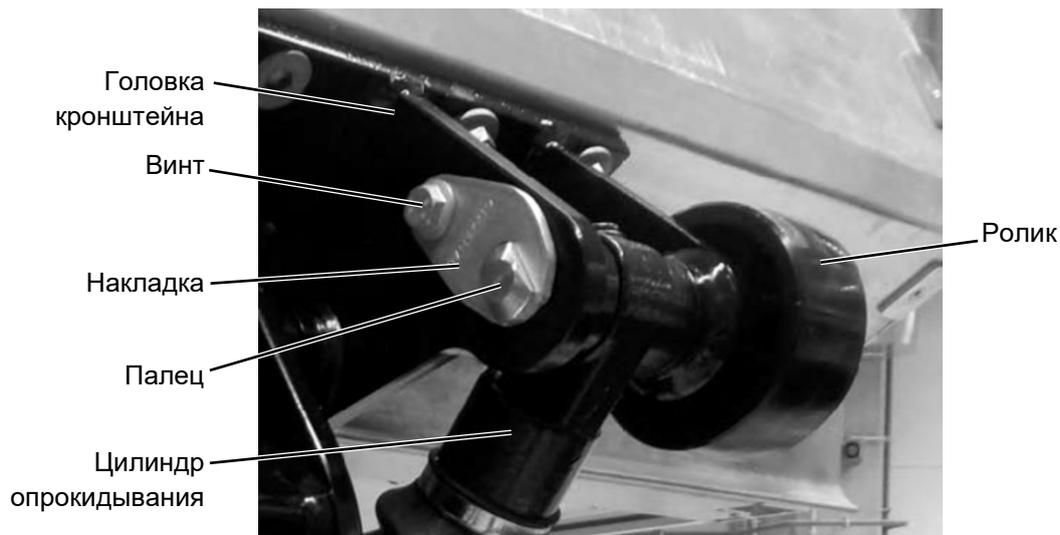
Рисунок 37: Установка цилиндра опрокидывания на палец
