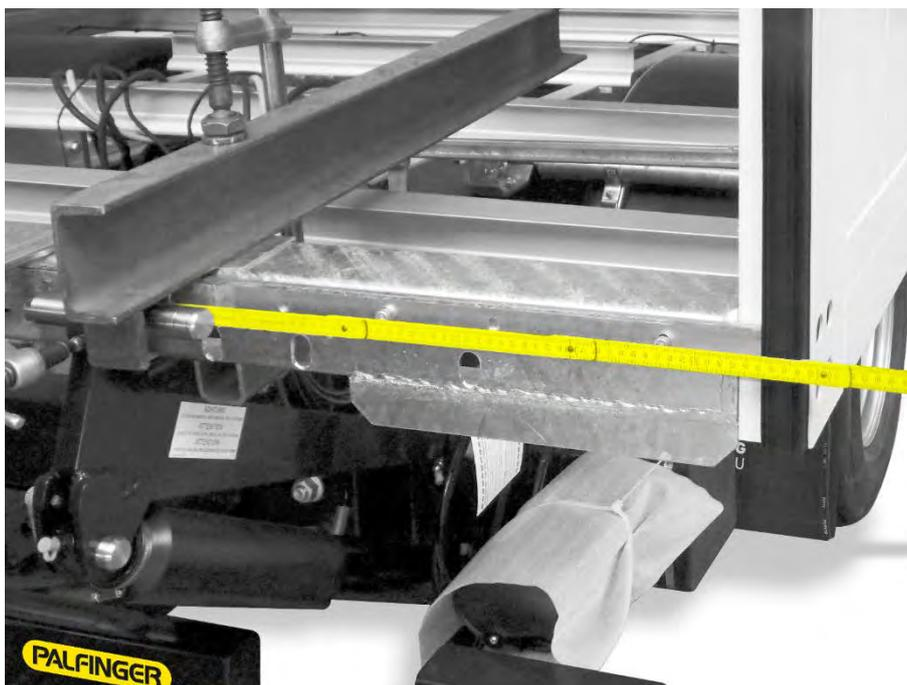
Рисунок 18: Контроль центрального позиционирования подъемного устройства (2)
