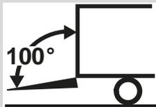
Se o sensor de inclinação **B15S** for ajustado para uma inclinação da plataforma muito íngreme, a carga pode cair da plataforma. As pessoas na plataforma podem correr risco de ferimentos graves ou mortais. Podem ocorrer danos materiais.
