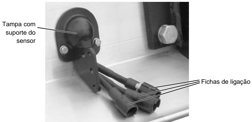
Imagem 40: Tampa com suporte do sensor para sensor de inclinação **B15**
