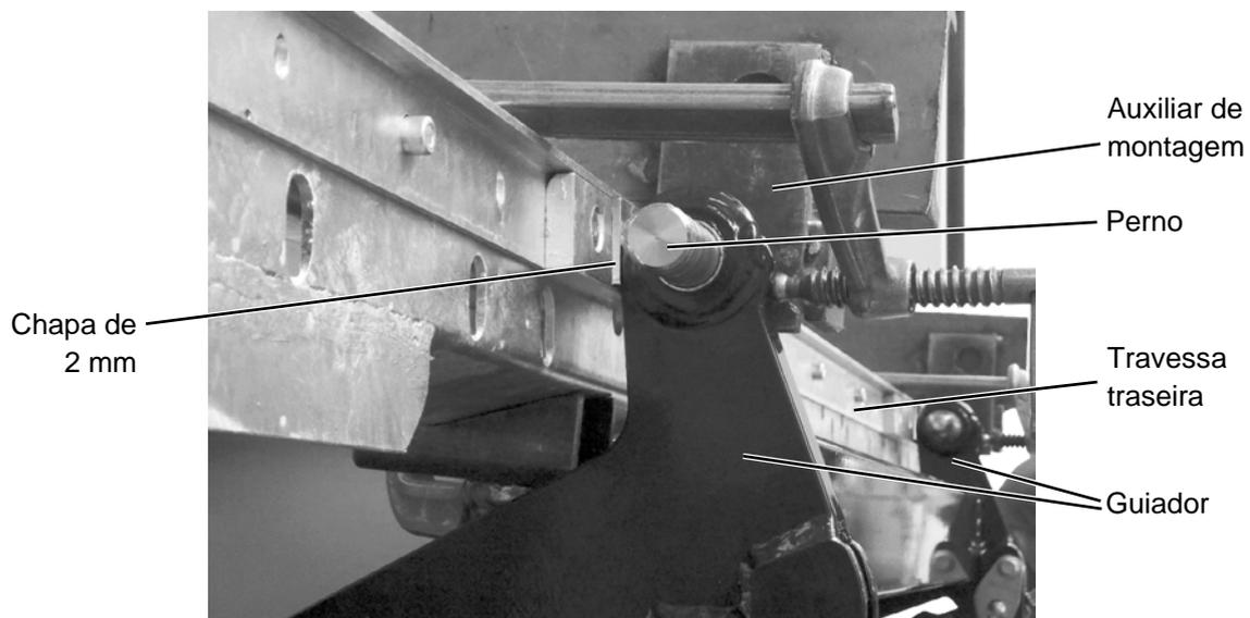
Imagem 16: Placas de união de 2 mm para a montagem de uma plataforma cromada
