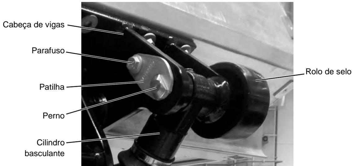
Imagem 37: Aparafusar o cilindro basculante
