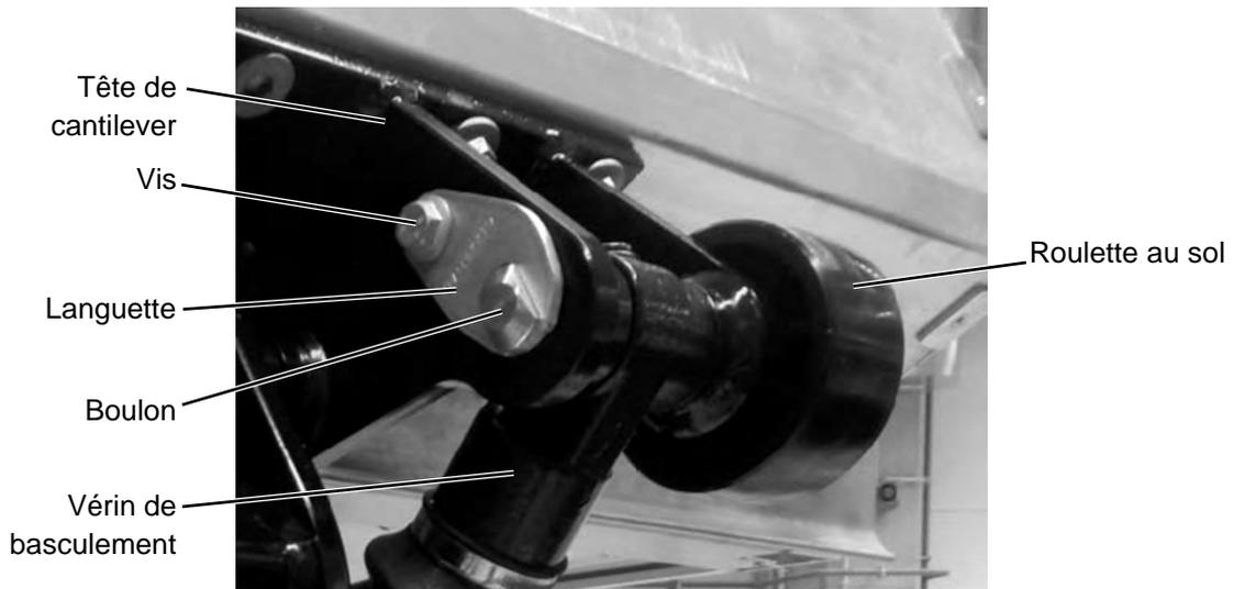
Figure 37 : Boulonnage des vérins de basculement
