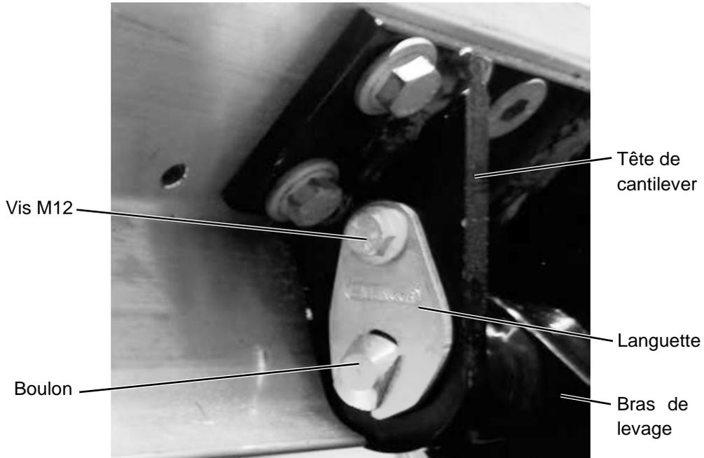
Figure 34 : Boulon, languette
