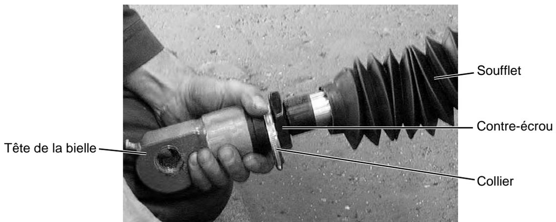
Figure 35 : Vérin de basculement
