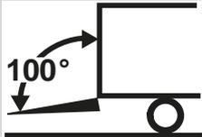
Si le capteur d'inclinaison **B15S** est ajusté sur une pente trop raide de la plate-forme, la charge peut rouler hors de la plate-forme. Il existe un risque de blessures graves, voire mortelles pour les personnes sur la plate-forme. Des dégâts matériels sont possibles.
