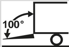
Si le capteur d'inclinaison **B15** est ajusté sur une pente trop raide de la plate-forme, la charge peut rouler hors de la plate-forme. Il existe un risque de blessures graves, voire mortelles pour les personnes sur la plate-forme. Des dégâts matériels sont possibles.
