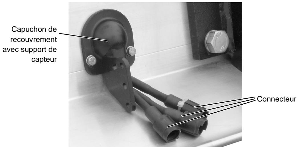
Figure 40 : Capuchon de recouvrement avec support de capteur pour capteur d'inclinaison **B15**
