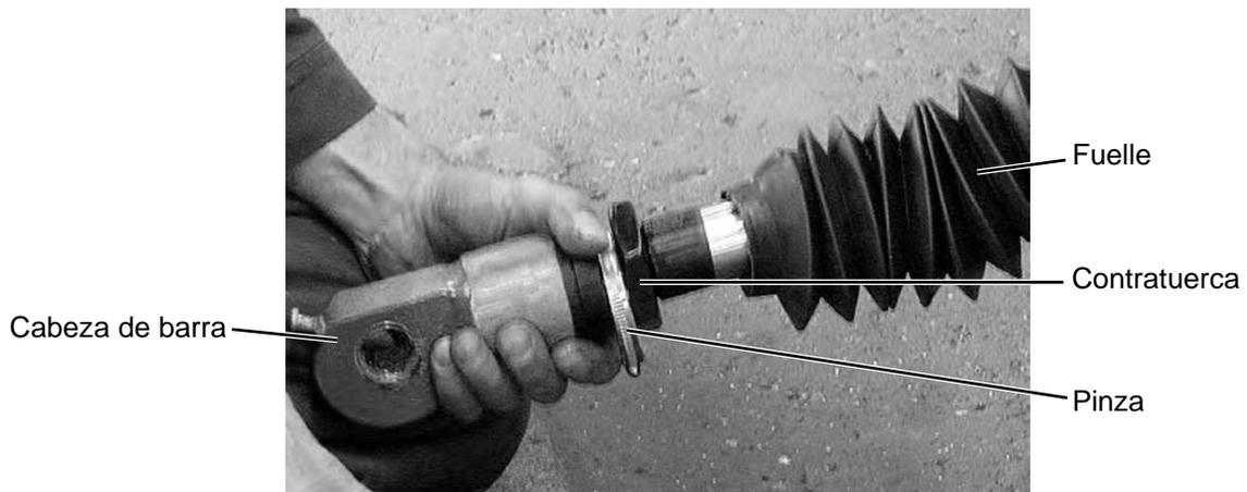
Figura 35: Cilindro basculante
