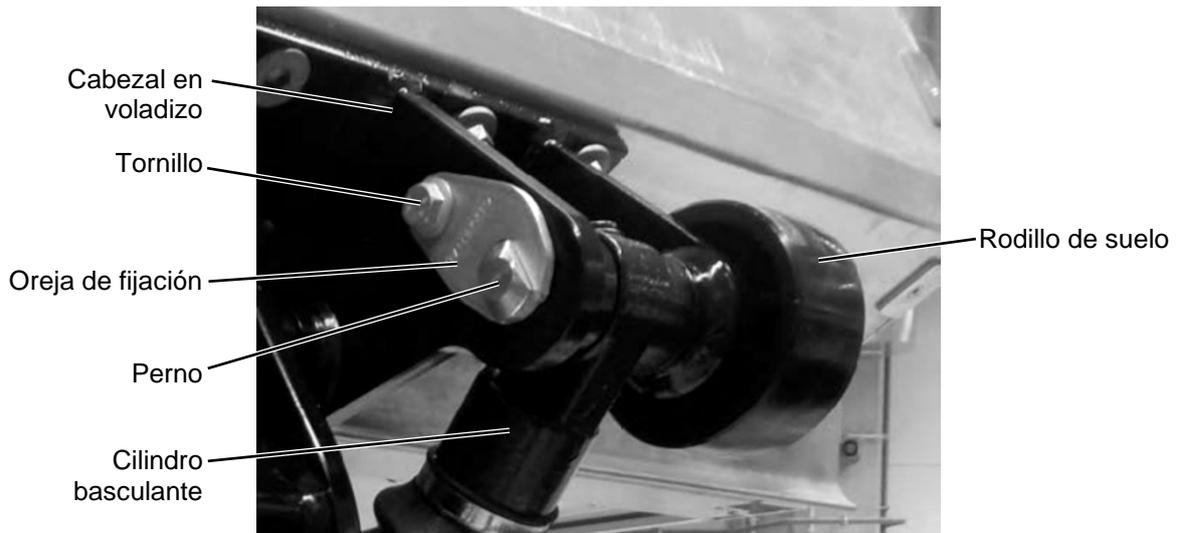
Figura 37: Empernar cilindro basculante
