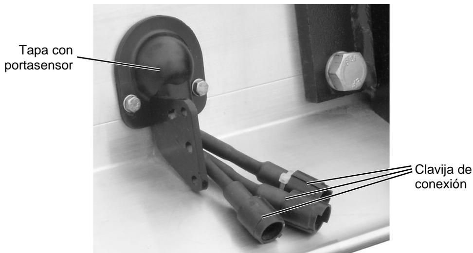
Figura 40: Tapa con portasensor para sensor de inclinación **B15**
