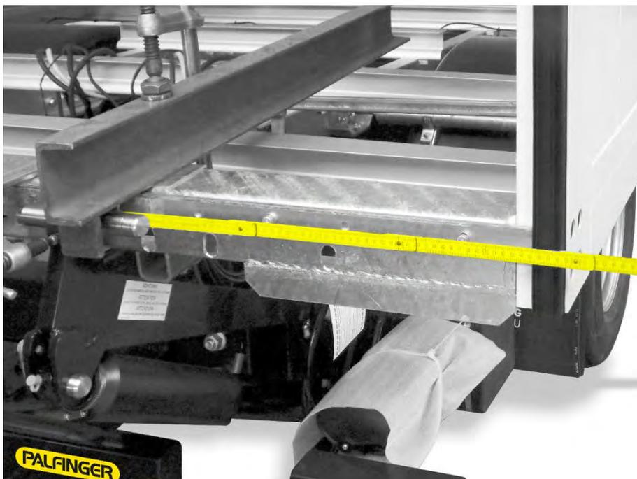
Figura 18: Comprobar la posición central del mecanismo de elevación (2)
