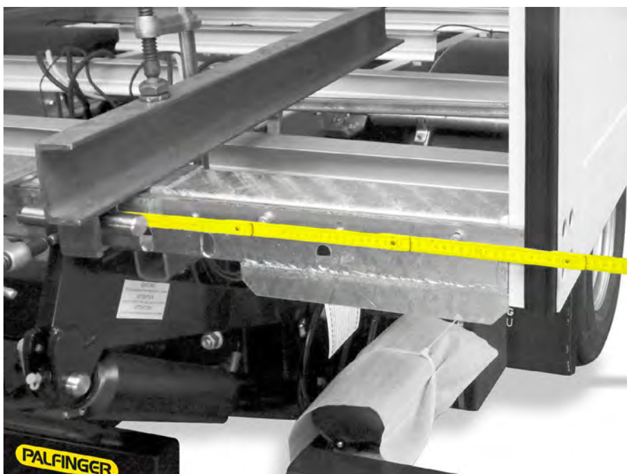
Abbildung 18: Mittige Position des Hubwerks kontrollieren (2)
