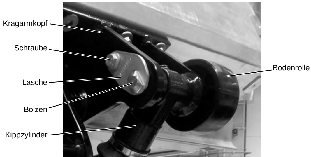
Abbildung 37: Kippzylinder verbolzen
