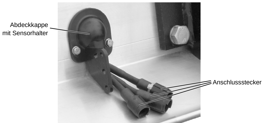
Abbildung 40: Abdeckkappe mit Sensorhalter für Neigungssensor B15
