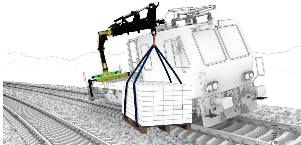
**Abb. 6:** Zusätzliche Momente auf Kranbauteile durch Kranneigung bis zu 10°, resultierend aus max. 8° Gleisbogenüberhöhung plus der Verwindung von Fahrzeugrahmen und Fahrwerk
