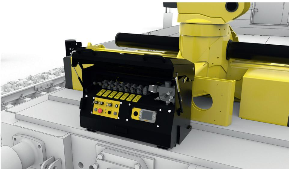
Abb. 2: Frei am Fahrzeug anzuordnender Notbedienstand mit Schlüsselschaltern für Hub- und Schwenkbegrenzer
