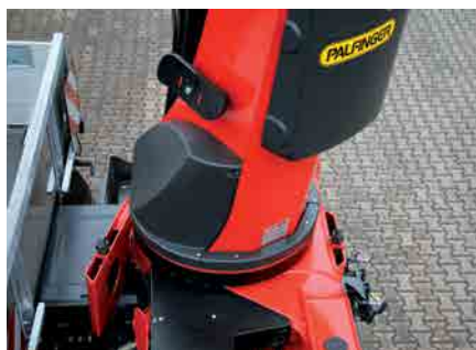
Sistema de rotación continua Movimiento sin restricciones
