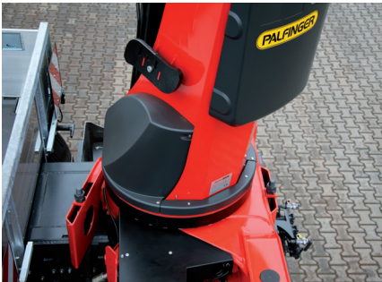
Sistema de rotación continua Movimiento sin restricciones
