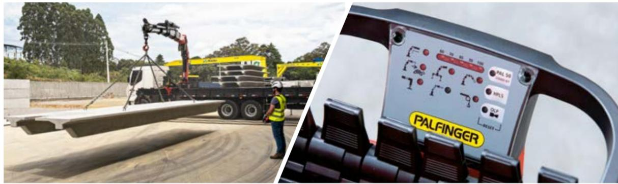
**Controlador de sobrecarga com bloqueio de operações PALTRONIC 40**
