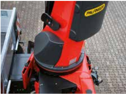
Sistema de rotación continua Movimiento sin restricciones
