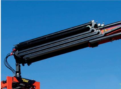
**Système de tuyaux pour engins additionnels\***
