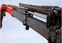
Wartungsarmes Schubsystem Reduziert den Serviceaufwand
