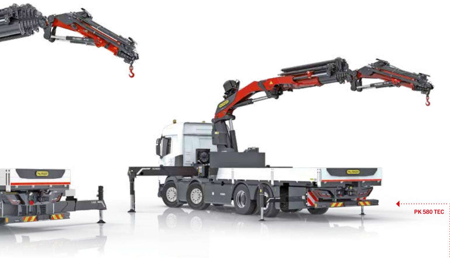
système Dual Power System Continuous (DPS-C) garantit que la capacité de levage maximale est disponible en mode fly-jib jusqu'au dernier mouvement. La solution idéale pour les applications nécessitant une longue portée, comme les travaux de toiture, mais aussi pour le levage de charges lourdes.
