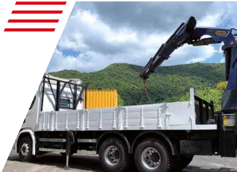
Estas grúas de carga realizan con facilidad trabajos de elevación a gran altura, con cargas pesadas en espacios reducidos. Una característica visible y muy apreciada es su perfil P poligonal, que confiere una gran rigidez y fuerza a todo el sistema de brazo, con un peso ligero. La mínima desviación del brazo del perfil P también ofrece mayor tranquilidad al operador durante las operaciones.
