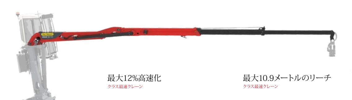
より大きな口径のパイプとホース、最適化された油圧マッチング、新開発の伸縮シリンダによって、高速かつ正確なクレーンの動作が可能となりました。GENERATION3クレーンモデルは、従来モデルよりも最大12%高速化されています。
