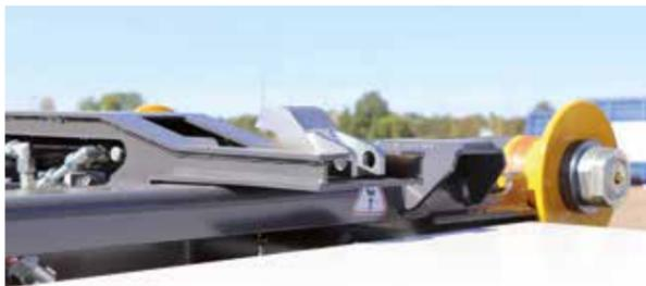
Le verrouillage hydraulique assure un transport sécurisé en maintenant fortement les conteneurs. Idéal pour des parcs de conteneurs de longueurs variées. Le conducteur l'active directement avec les commandes en cabine.
