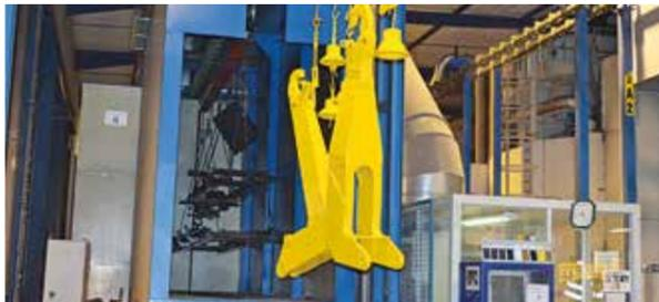
Longue durée de vie : toutes les pièces sont sablées, dégraissées, apprêtées et recouvertes d'une couche de finition par procédé électrostatique selon la norme ISO 12944, classes 3-15 ans.
