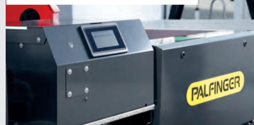
Die Akkupakete ermöglichen den vollständig elektrischen Betrieb der Bühne für einen ganzen Tag, wodurch ein emissionsarmer Einsatz vor Ort ermöglicht wird. Der bleibt der Motor während des Bühnenbetriebs ausgeschaltet, was für reduzierte Emissionen und minimale Geräusentwicklung sorgt. Diese Technologie eröffnet neue Einsatzmöglichkeiten, z. B. in Städten mit strengen Emissionsvorschriften oder geräuschempfindlichen Bereichen – und steigert die Effizienz und die Rentabilität.
