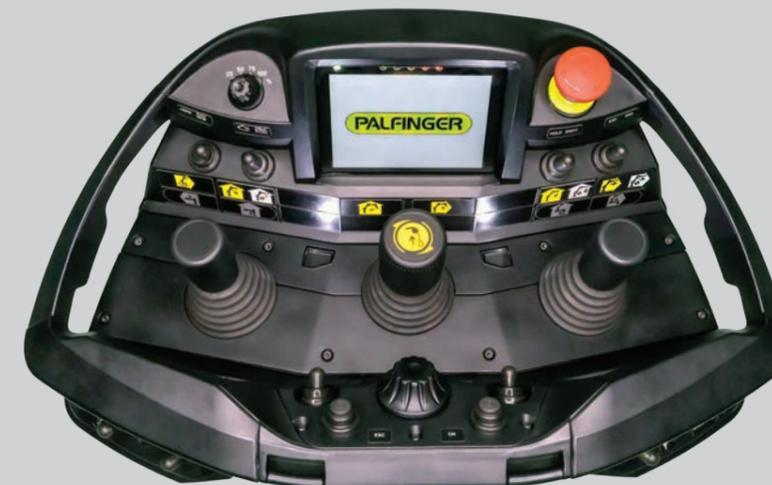
Smart Control permite mover la punta de la grúa horizontal o verticalmente accionando una única palanca. Basta que el operador especifique la dirección de la punta de la grúa; la electrónica (Paltronic) combina los movimientos necesarios en segundo plano para alcanzar exactamente la posición deseada. Accionando la palanca en dos direcciones, también es posible realizar movimientos en diagonal y trazar curvas en el espacio.
