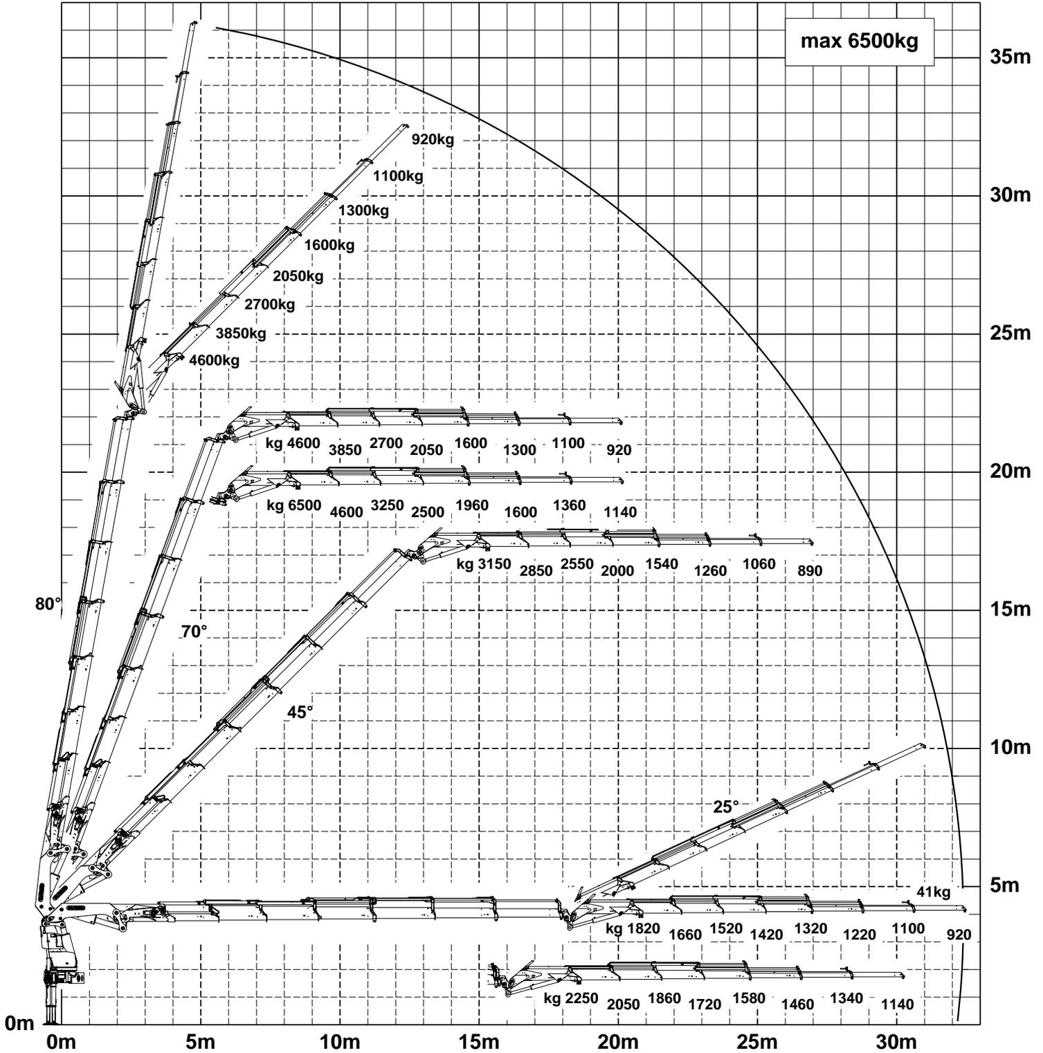
Las cargas máximas indicadas en el diagrama se reducen por el peso propio de las prolongas manuales que estén montadas.
