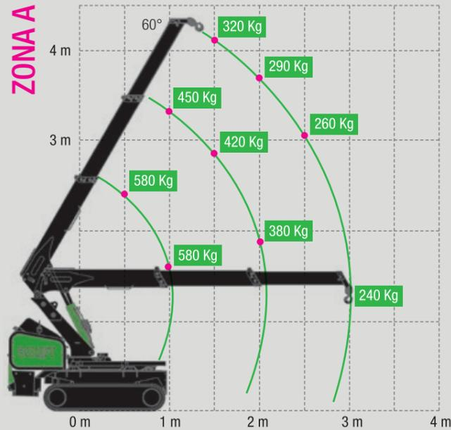
DIAGRAMA DE FUNCIONAMIENTO DE GIRO CON CARRO CERRADO
