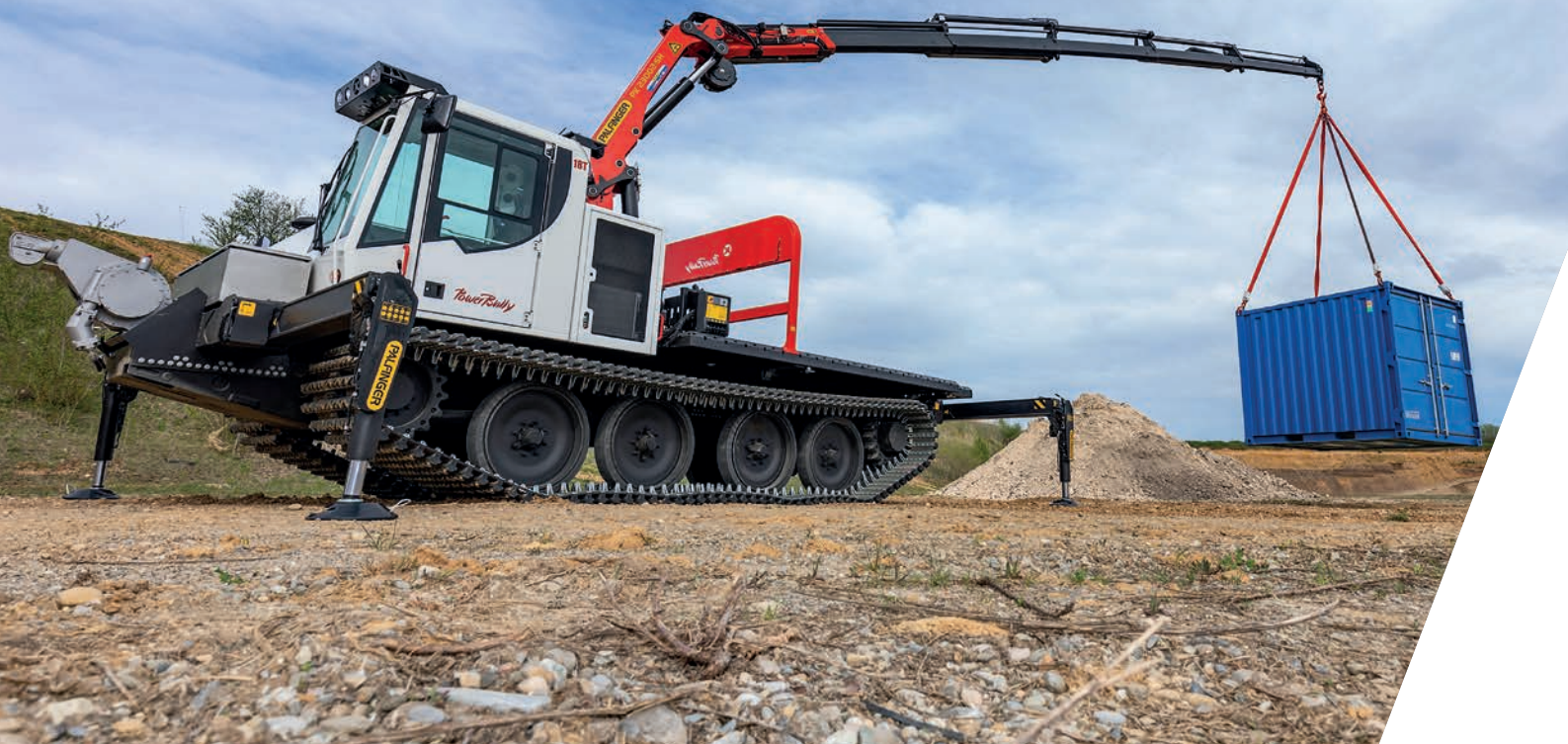
Ladekran auf PowerBully bei der Versorgung von Baustellen im Gelände
