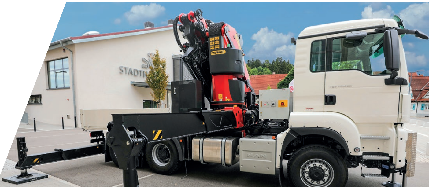
PK 53002 SH mit Hybridantrieb, auf 3-Achs-Kranfahrzeug
