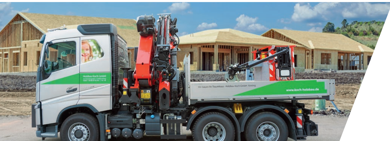
PK 53002 SH als Kranfahrzeug mit Pritsche, als Hänger- oder Sattelzug
