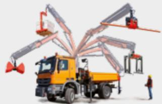
Ausgerüstet mit dem passenden Zusatzgerät arbeitet der Kran multifunktional und wirtschaftlich. Ob hydraulisch oder mechanisch – PALFINGER bietet ein umfangreiches Angebot an Zusatzgeräten und Ausrüstungen, um den Ladekran zu einem flexiblen und vielseitig einsetzbaren Werkzeug zu machen.
