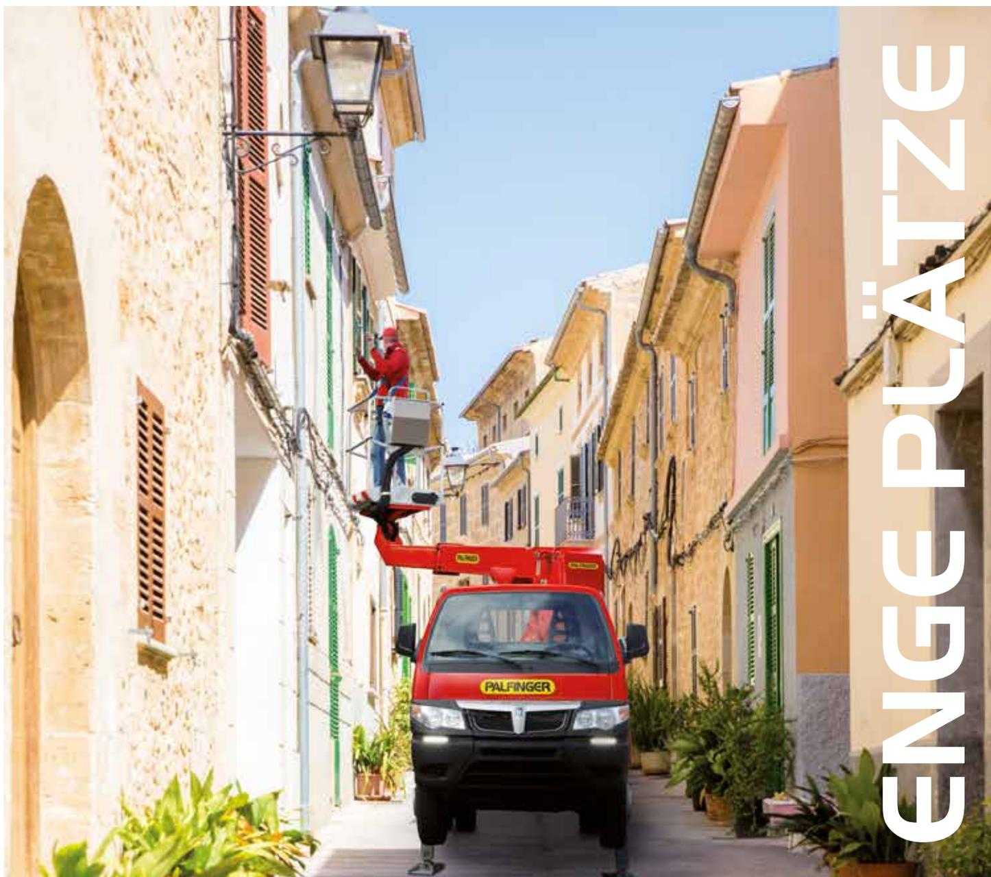
Steile Steigungen, enge Durchgänge, schmale Straßen: alles kein Problem für die neuen PALFINGER Hubarbeitsbühnen P 90 T und P 160 A der Smart-Klasse. Das kleine Wunderwerk von PALFINGER Platforms Italy ist das ideale Werkzeug bei begrenztem Platz. Die Hubarbeitsbühnen eignen sich mit ihrer maximalen Arbeitshöhe von 8,80 Metern/16 Metern perfekt für die Jungbaumpflege, Wartungsarbeiten an Straßenlaternen oder das Freischneiden des Lichtraumprofils an Straßen, Rad- und Gehwegen.
