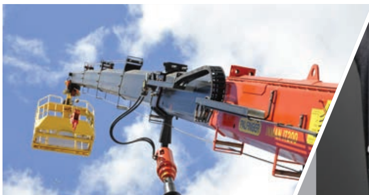
6-гранное сечение профиля стрелы Высокие прочностные характеристики.
