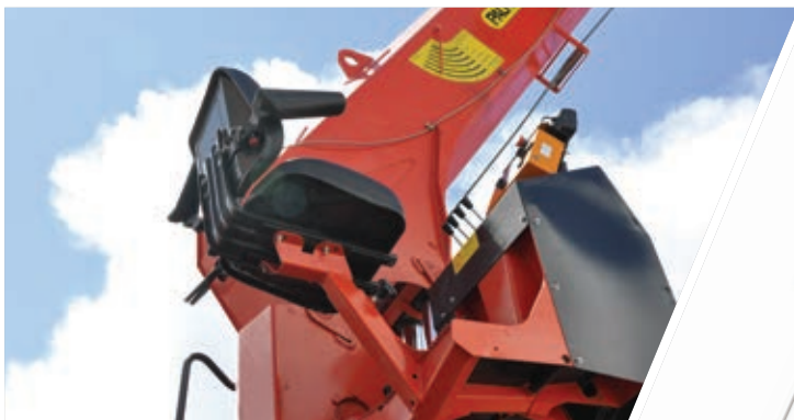
Комфортный верхний пост управления Новый защитный кожух и удобное сиденье.
