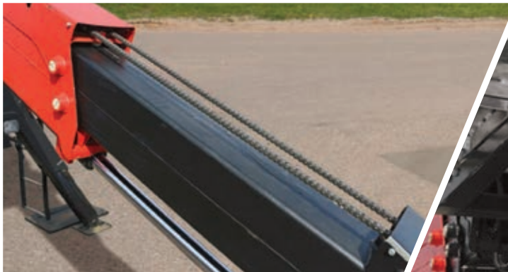
Цепная синхронизация выдвигания стрел Обладает большей надежностью и долговечностью по сравнению с тросовой.
