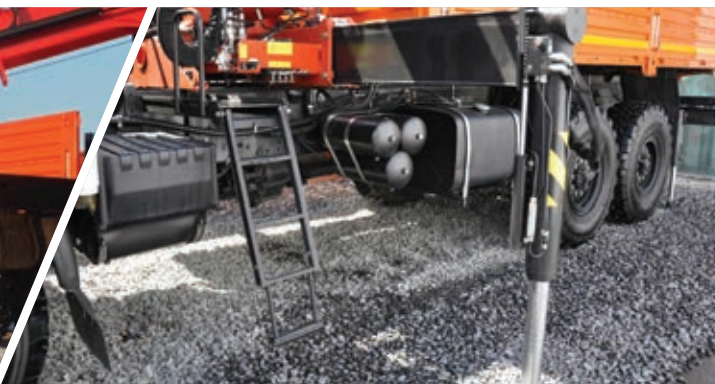
Ширина раздвижения балки опор 5 640 мм Максимальная устойчивость автомобиля при выполнении погрузо-разгрузочных, буровых и монтажных работ.
