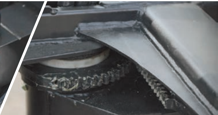
Металлическая шестерня и рейка поворота корзины Обеспечивают надежность и точную работу конструкции.
