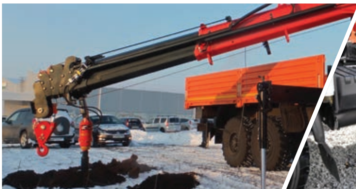
Отрицательный угол наклона стрелы до -17° Позволяет проводить буровые работы, а также опускать рабочую корзину до уровня земли.
