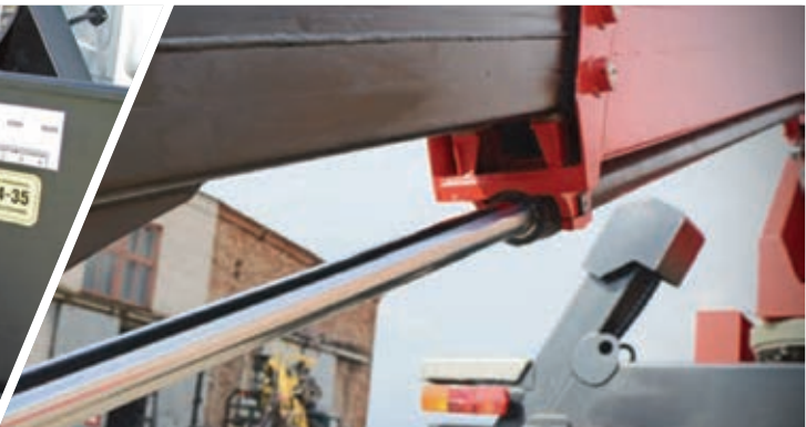
Гидроцилиндр телескопирования расположен снизу Обеспечивает достаточную защиту без необходимости увеличения сечения стрел.
