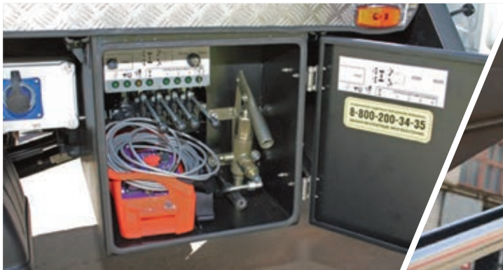
Ящик для перевозки гидрооборудования и пульта ДУ Установлен справа по борту шасси.
