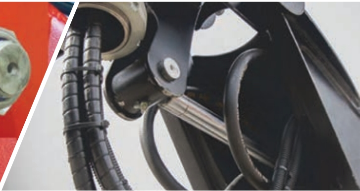
Защита РВД и проводов Электропроводка и шланги гидравлики расположены внутри стрелы.
