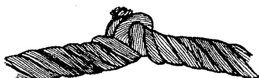
Рис.12: Перекручивание каната
