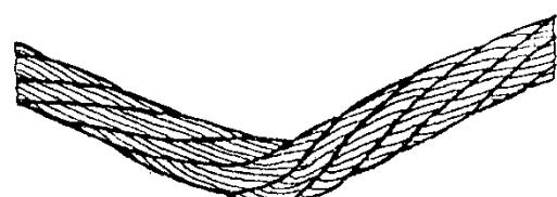
Рис.13: Залом каната (перегиб)
