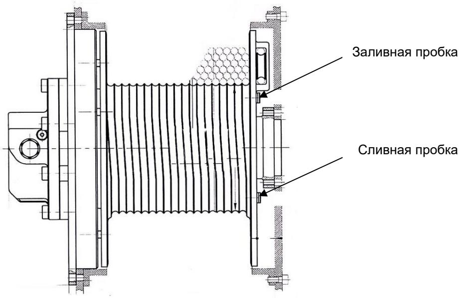
*Рис. 14: Лебедка с расположением сливной и заливной пробок на боковой (торцевой) поверхности барабана*
