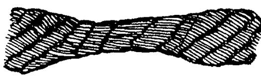
Рис.11: Раздавливания каната
