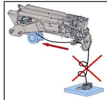
В случае если нижние слои каната на барабане редко используются, канат следует разматывать через каждые 100 часов работы и затем под натяжением наматывать вновь для уплотнения слоев.
