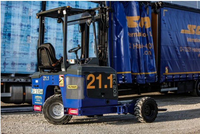
Heckmontierter PALFINGER Mitnahmestapler FLC 203
