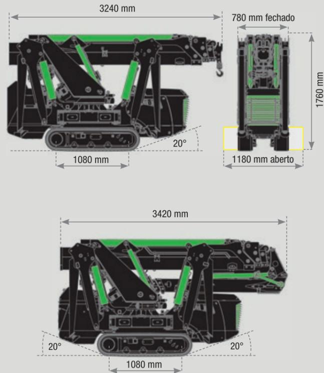
Dimensões ( A x L x C ): 1,76 x 0,78 x 3,24 m
