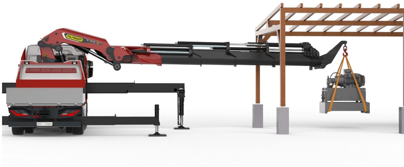
Umsetzbarer Einsatz, dank Powerlink Plus (Knickarm-Überstreckung) und Versatz des Anschlagpunktes.
