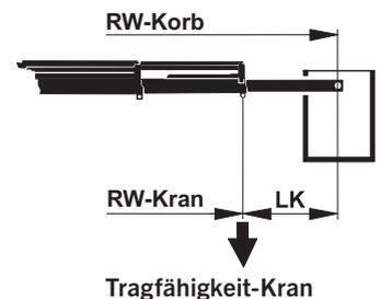
**Um die Sicherheit im Arbeitskorbbetrieb zu gewährleisten** wird ebenfalls empfohlen, den Kran voll abzustützen und die Standsicherheit im gesamten Arbeitsbereich zu gewährleisten. Die in der EN 280 vorgeschriebenen **maximalen Krangeschwindigkeiten** im Arbeitskorbbetrieb sollten ebenfalls **nicht überschritten** werden!
