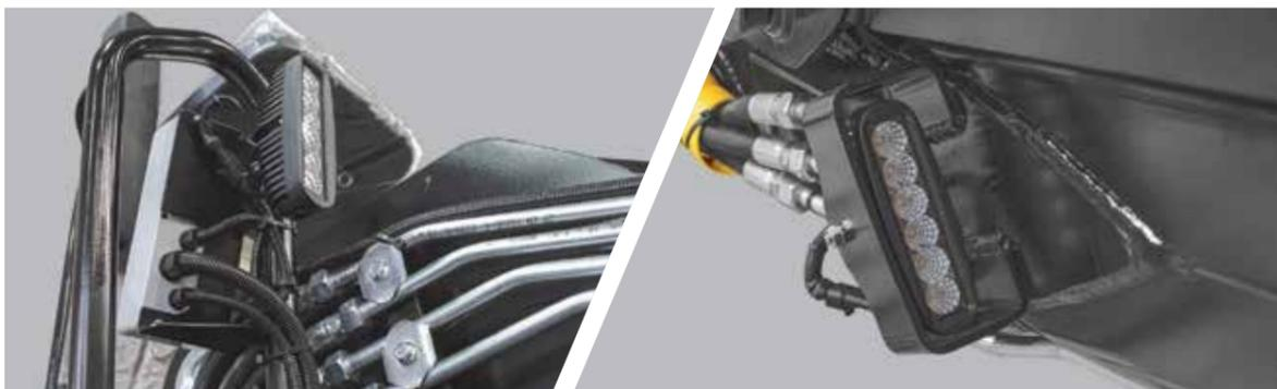
Светодиодные фары дают отличную освещенность и позволяют не снижать темп работы в темное время суток. Фары защищены со всех сторон от случайных ударов, а также от пыли и влаги (класс защиты IP66).
