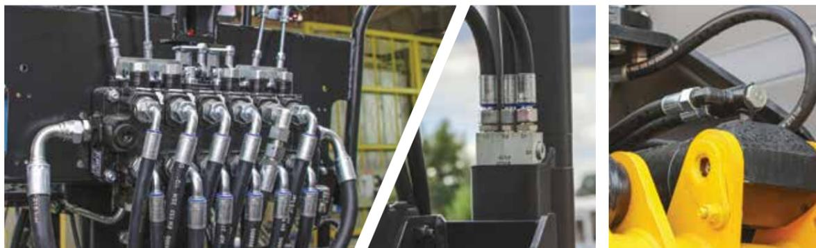
Гидрораспределитель спроектирован и произведен специально для этих кранов. Обеспечивает высокую точность и плавность выполнения операций. Насос от перегрузок защищают предохранительные клапаны на гидрораспределителе.
