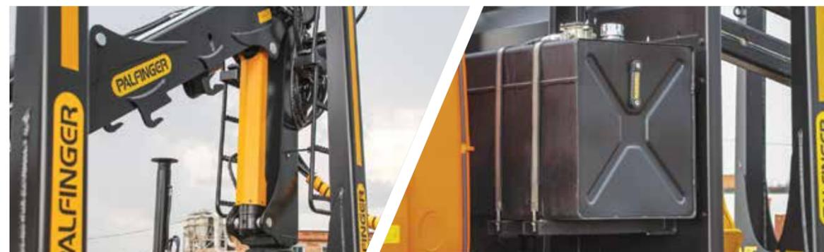
Уменьшенный объем основных гидроцилиндров увеличивает скорость работы манипулятора на 30–35%. Гидроцилиндр подъема стрелы и ротатор защищены специальными кожухами.
