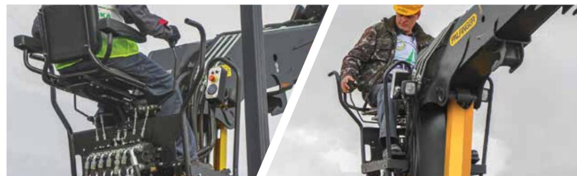
Рычаги управления размещены по бокам. За счет расположения гидрораспределителя под сиденьем оператора уменьшена длина всех тяг, а их сочленения выполнены с помощью шарниров, что сводит люфт к минимуму. Безопасность соответствует требованиям ГОСТ.
