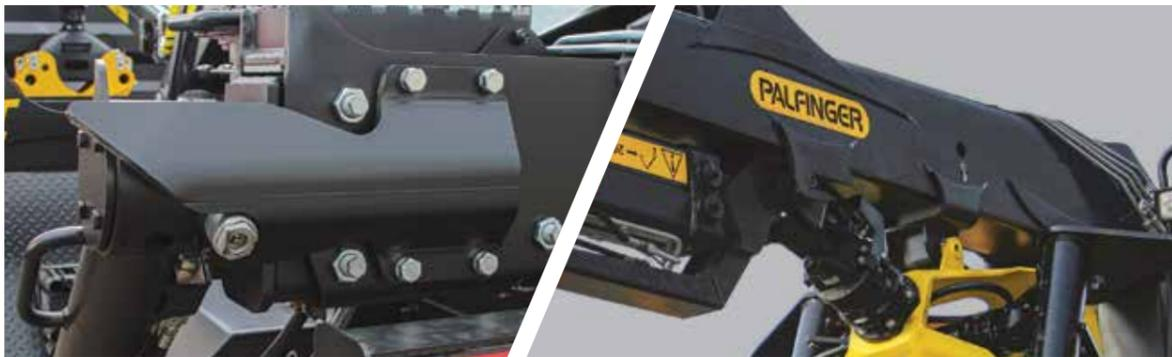
Во всех исполнениях манипуляторов класса VM, оснащенных гидравлическим выдвиганием аутригеров балок, используются копиры усиленной конструкции, монтируемые на 4 болта с применением стопорных шайб Nord-Lock.
