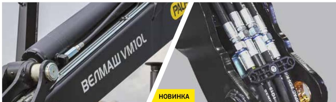
Для предотвращения падения груза и металлоконструкции манипулятора в случае разрыва трубопровода на гидроцилиндрах подъема стрелы и рукояти установлены аварийные клапаны.
