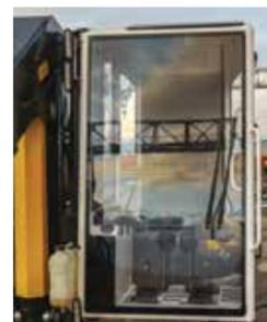
Ударопрочное поликарбонатное переднее стекло на всю высоту кабины с антиабразивным покрытием LEXAN может использоваться без металлической решетки.
