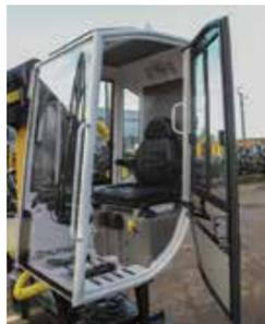
Конструкция выполнена из высокопрочных стальных профилей.
