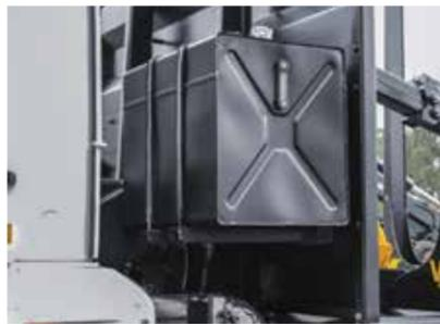
**ГИДРОБАК.** Устанавливается на щите, минимизируя риск повреждения. Два типа баков в зависимости от компоновки шасси.
