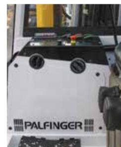
Кнопки аварийного останова и подачи сигнала, управление обогревателем и вентилятором, внутренним и наружным освещением, стеклоомывателем и стеклоочистителем находятся на специальной панели в удобном доступе.
