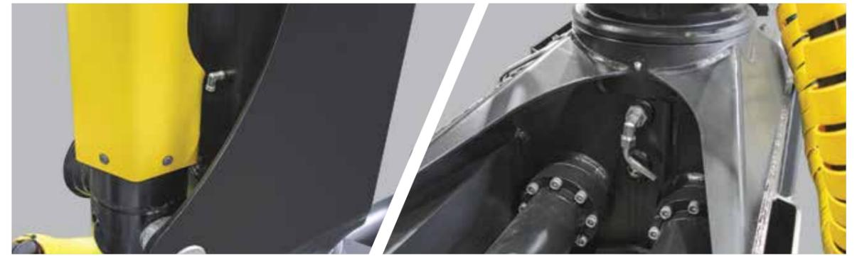
Для предотвращения образования разгерметизации в полостях основания и колонны и засасывания влаги внутрь основания и масла из ОПУ, установлены сапуны для вентиляции.
