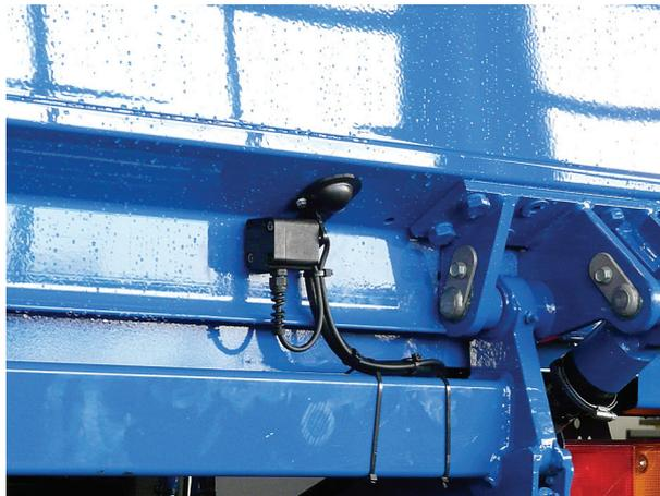
Ein Neigungssensor b15 ist bildlich dargestellt. Der Neigungsschalter b16 wird ebenfalls mit dem Kabel nach unten montiert.
