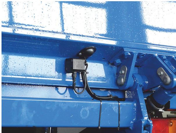
Un capteur d'inclinaison b15 est représenté. Le capteur d'inclinaison b16 se monte également avec le câble vers le bas.
