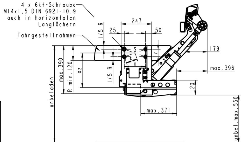
Mindest-Schraubenabstand Konsolblech im Fhz.-Rahmen für M12x1,5 mit Wsi min=48cm<sup>3</sup> und xmin=172mm z.B. x/z: 175/36+72 x/z: 87,5+175/120
