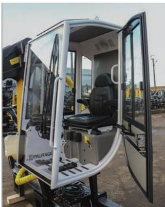
При проектировании учтен 20-летний опыт производства кабин Palfinger. Каркас кабины, остекление и электрооборудование изготовлены в Европе.
