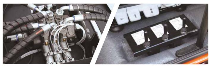
Гидрораспределитель с пневматическим управлением. Простая система пневматического управле- для оператора месте. ния. Надежная в условиях российского климата.
