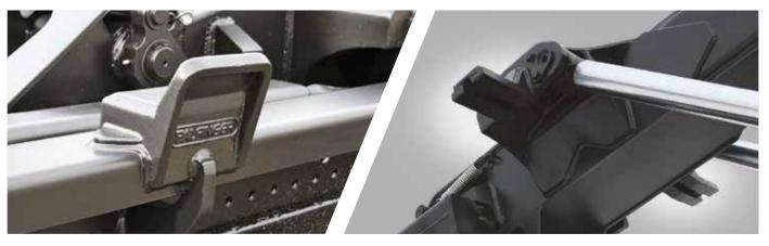
4 литые опоры. Износостойкие опоры предотвращают боковое смещение бункера при транспортировке.
