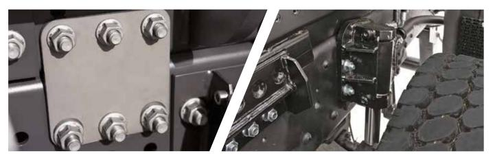
Болтовой монтаж. Ряд отверстий по несущей раме облегчает монтаж и исключает сварочные работы.
