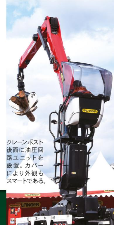
クレーンポスト後面に油圧回路ユニットを設置。カバーにより外観もスマートである。
